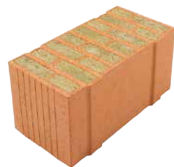
Porotherm 50 W.i Plan U-Wert 0,12 W/m²K (verputzt)* Format (D x L x H) 50 x 25 x 24,9 cm Bedarf 16 Stk./m² Masse 19,3 kg/Stk.
