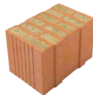
Porotherm 38 W.i Plan U-Wert 0,16 W/m²K (verputzt)** Format (D x L x H) 38 x 25 x 24,9 cm Bedarf 16 Stk./m² Masse 14,7 kg/Stk.
